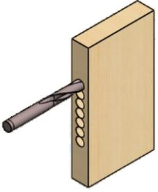
2. Com uma furadeira e uma broca de 15 mm faça furos dentro da área demarcada com profundidade suficiente para acomodar a trava. Do mesmo modo, faça o furo para passagem do cilindro.
