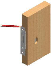
4. Coloque a fechadura no rasgo encostando a testa contra a lateral da porta. Marque o encaixe da testa. Faça o rebaixo com um formão para encaixá-la.
