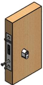
5. Coloque novamente a fechadura na porta, instale o cilindro e fixe os parafusos.
