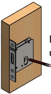
1. Determine previamente a altura da trava na porta. Em geral usa-se a 1,05m do chão. Encoste a própria trava na porta como gabarito, marque com um lápis o contorno da fechadura e o furo do cilindro.
