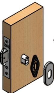
7. Por fim, instale as rosetas de forma centralizada e teste o funcionamento da fechadura.
